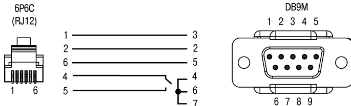
Рисунок В.2 – Схема кабеля КС3 для подключения модема к ОВЕН ПЛК150 по интерфейсу RS-232 Debug
