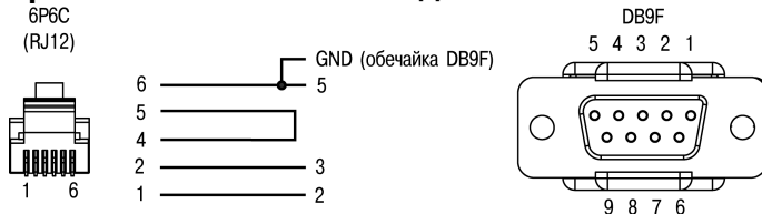
Рисунок В.1 – Схема кабеля программирования КС1, входящего в комплект поставки
