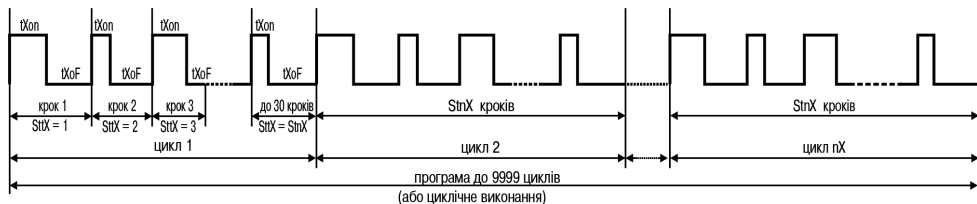
Рисунок 7.3 – Принцип роботи таймера
