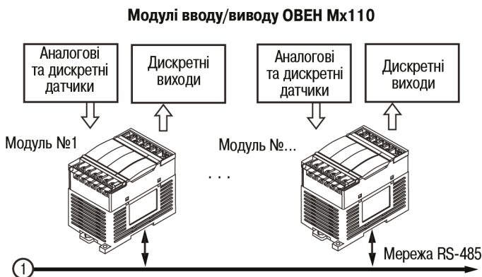
Рисунок 6.4 – Приклад структури з'єднань при використанні контролера у системі
