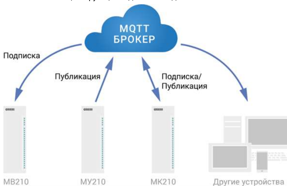
Рисунок 6.2 – Структурная схема обмена по протоколу MQTT
