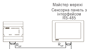
Рисунок 6 – Типова схема підключення для PR100 у режимі Slave
