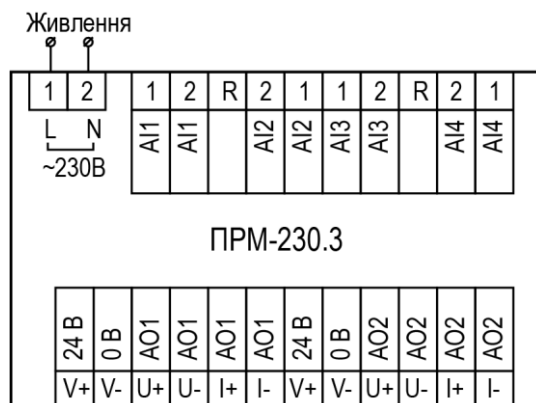
Рисунок 5.3 – Призначення контактів клемника пристрою із живленням 230 В
