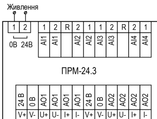
Рисунок 5.2 – Призначення контактів клемника пристрою із живленням 24 В
