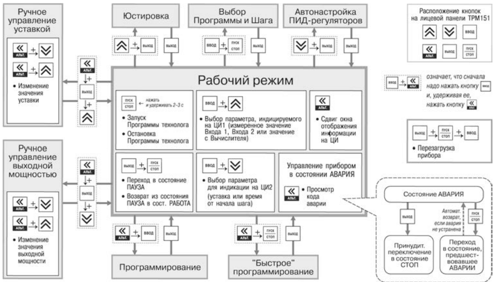
Рисунок 3.12 – Схема переключения режимов прибора
