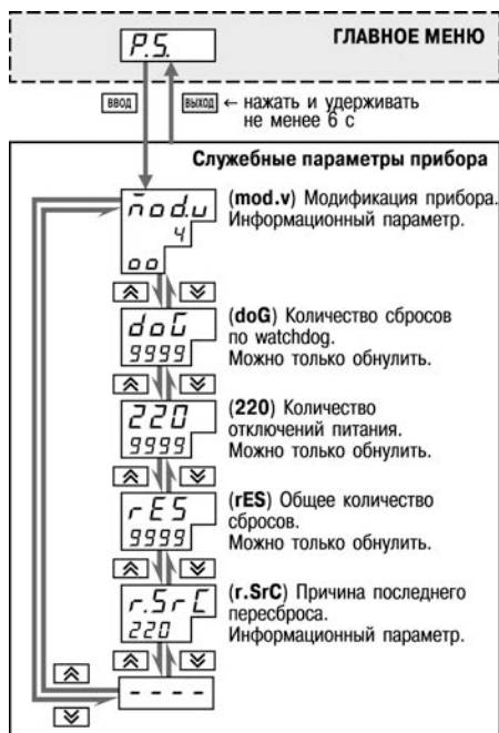
Рисунок 9.19– Схема доступа к службным параметрам прибора
