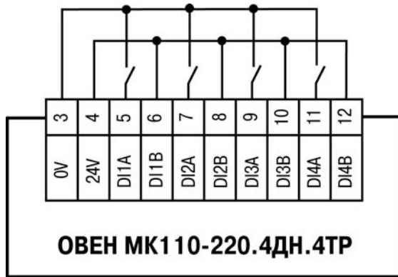
Рисунок Б.3 – Схема подключения к ОВЕН МК110-220.4ДН.4ТР дискретных датчиков с выходом типа «сухой контакт»
