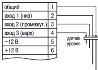
Рисунок Б.2 – Схема подключения кондуктометрических датчиков уровня
