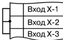
Рисунок Б.9 - Схема установки перемычек на неиспользуемый вход
